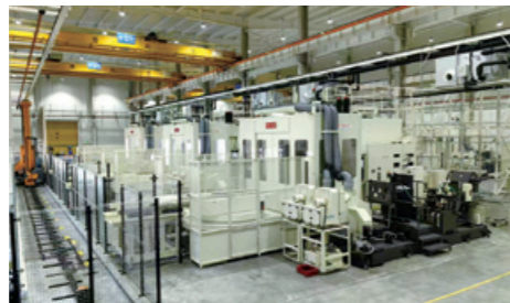
海塩工場全自動フレキシブル生産ライン
